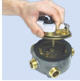
Setzen Sie die Abdeckung/Patroneneinheit umgedreht auf das Gerät und die Dichtscheibe.
