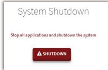
È possibile avviare la funzione di spegnimento prima di rimuovere l'alimentazione di rete per lavori di manutenzione o cambio di posizione. La tensione di alimentazione di rete può essere scollegata quando il touch screen è nero e il LED rosso nella parte anteriore si accende. Se non si rimuove la tensione di rete, il WebLog riavvia il sistema operativo e il software applicativo.
