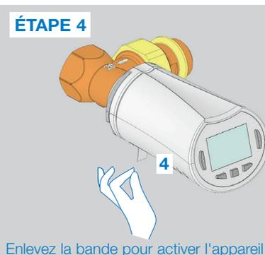
Lorsque le produit est sous tension, la tête thermostatique démarre la procédure d'auto-apprentissage de la course.
