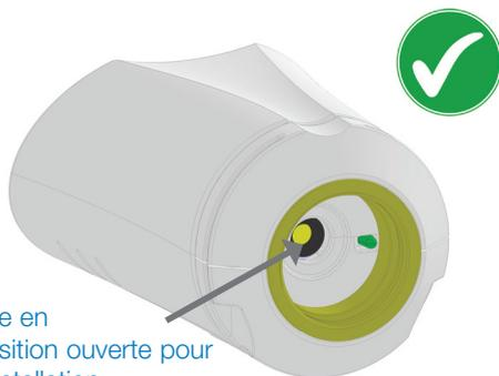
Axe en position ouverte pour l'installation
