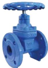
Cuneo gommato, vite interna, guarnizione stelo superiore con tre O-ring, boccola di tenuta a elevata resistenza, rivestimento epossidico
