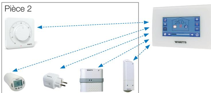
**Type 2** - (Pièce avec thermostat et un ou plusieurs récepteurs ou têtes thermostatiques)
