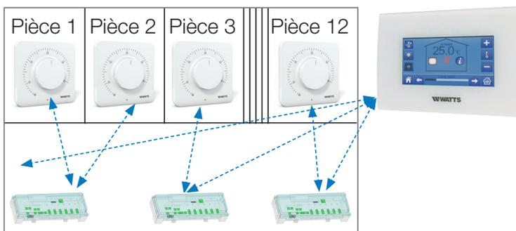
**Type 3** - (Système de chauffage au sol)
