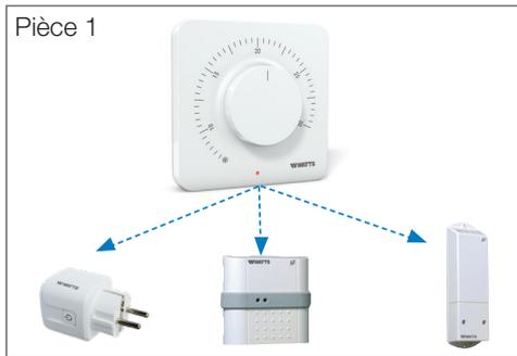
**Type 1** - (Pièce avec thermostat et un ou plusieurs récepteurs)
