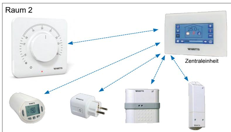
Typ 2 - (Raum mit Thermostat und einem oder mehreren Empfängern oder Thermostatköpfen).
