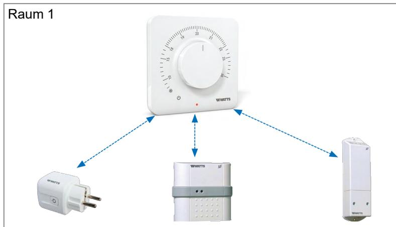
Typ 1 - (Raum mit Thermostat und einem oder mehreren Empfängern)
