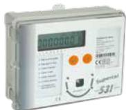
La contabilizzazione dell'energia termica viene effettuata mediante il misuratore di energia termica, Serie Supercal 531, che riceve il segnale di portata dal misuratore volumetrico e, sfruttando il valore delle sonde di temperatura, contabilizza l'energia termica utilizzata.
