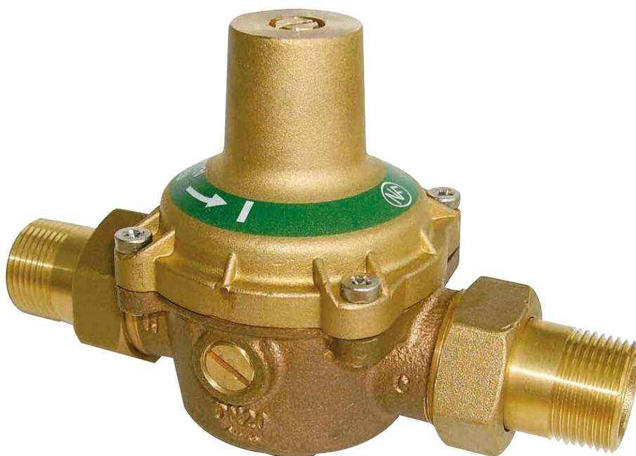
I riduttori di pressione Desbordes 11 DO hanno il corpo in bronzo. Grazie alla loro progettazione, sono insensibili al calcare e alle impurità e non necessitano di manutenzione. Si prestano anche al passaggio di aria compressa, gas neutri e olio combustibile in circuiti a temperatura ambiente. Per questo tipo di applicazioni, rivolgersi all'azienda.
