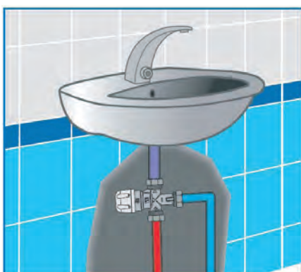
Podumywalkowy montaż termostaticznego zaworu mieszającego typ RLT, wlot zw z prawej, cw pionowo z dołu
