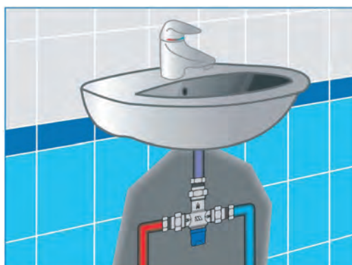
Podumywalkowy montaż termostaticznego zaworu mieszającego typ MMV-C, dopływ cw i zw bocznie
