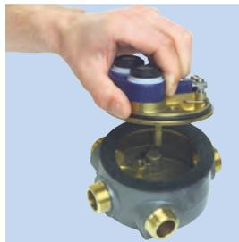
Placer l'ensemble tampon/cartouche à l'envers sur l'appareil et le joint plat.
