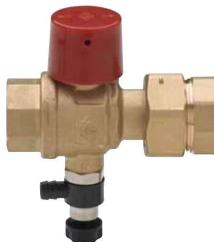
Art. 4634 serie EXPO-SFER Valvola a sfera con rubinetto di scarico e cappuccio sigillabile per il collegamento e la manutenzione dei vasi di espansione.
