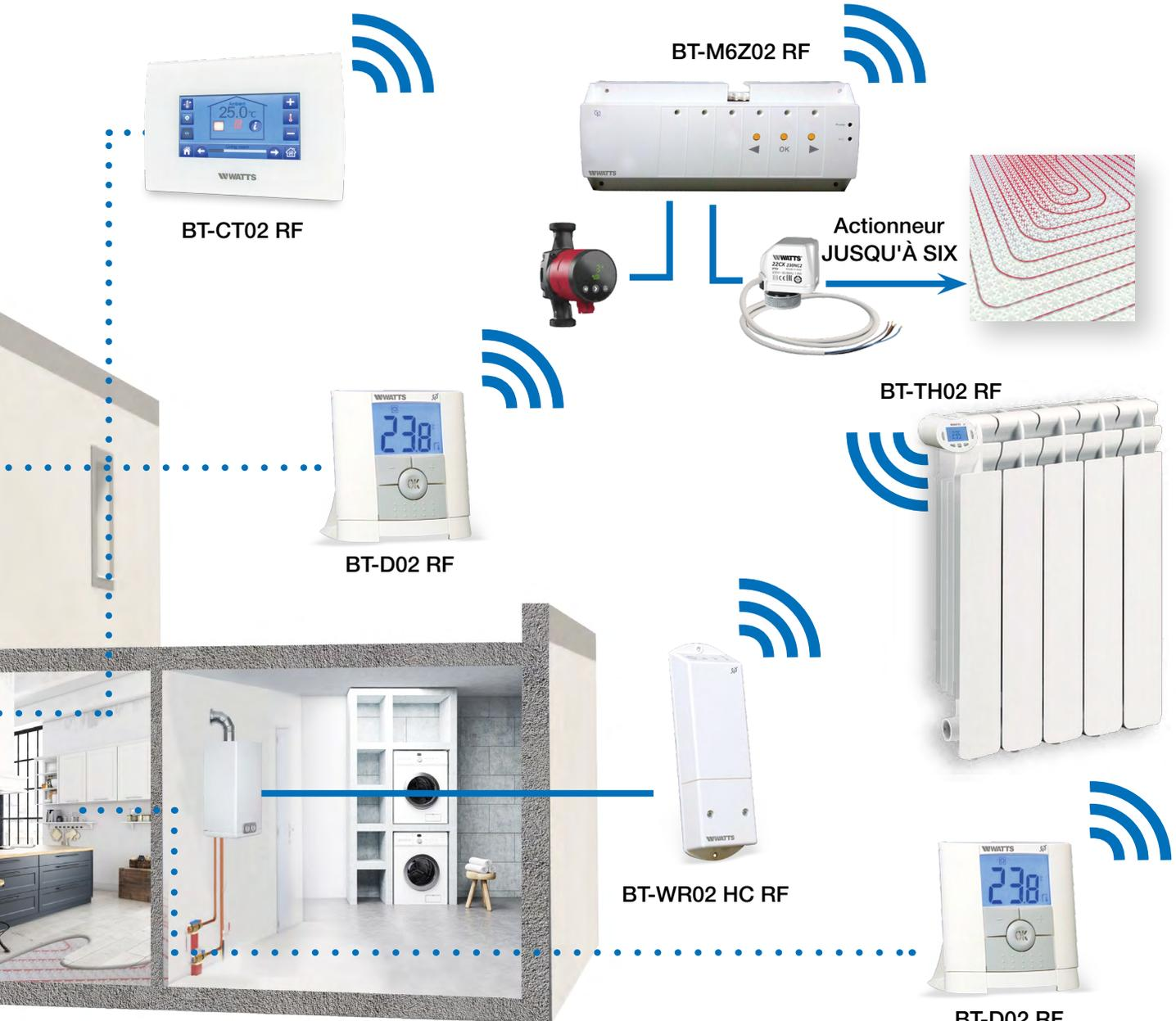
5. Appairez comme appareil de chauffage chaque BT-TH02 RF dans chaque pièce virtuelle créée dans la BT-CT02 RF en sélectionnant le circuit hydraulique. Il est possible d'appairer plusieurs BT-TH02 RF dans la même pièce.
