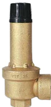
Válvula de seguridad de membrana con regulación fija. Cuenta con cuerpo y casquete en latón CW617N. PN10. Sobrepresión: 10%. Desviación de cierre <20%.
