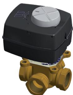
Válvula mezcladora de sector de 4 vías con actuador bidireccional de 3 puntos. PN 10 bar. Temperatura de trabajo: 0÷110°C. Cuenta con cuerpo y rotor en latón y juntas en EPDM. Acoplamientos roscados hembra de 1/2" a 2". Ángulo de rotación de 90° en 120 seg.
