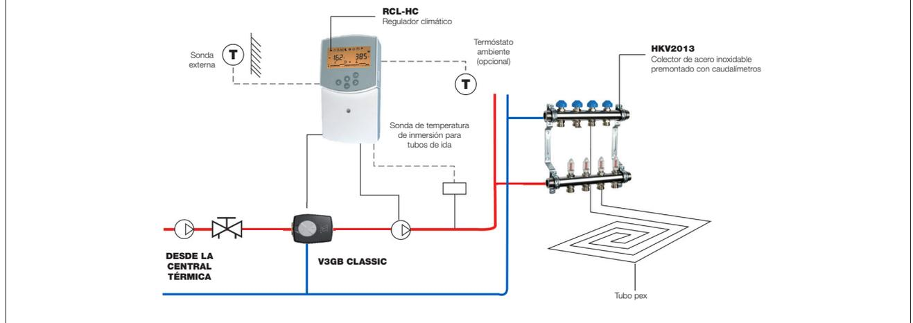
Las válvulas de la **Serie V3GB CLASSIC** de 3 vías funcionan tanto como válvulas desviadoras cuanto como válvulas mezcladoras en función de su conexión con la instalación.
