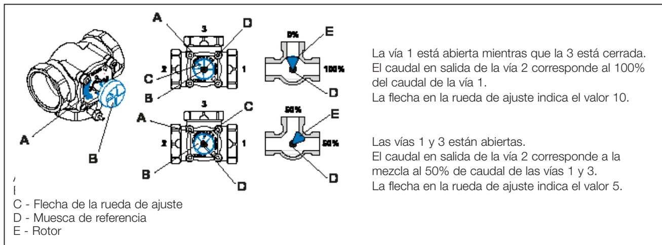
La placa en aluminio de la válvula cuenta con dos escalas graduadas en los dos lados: una para la rotación hacia la derecha y otra hacia la izquierda. Para pasar de una a la otra, desenrosque los dos tornillos de sujeción, voltee la placa y vuelva a fijarla.
