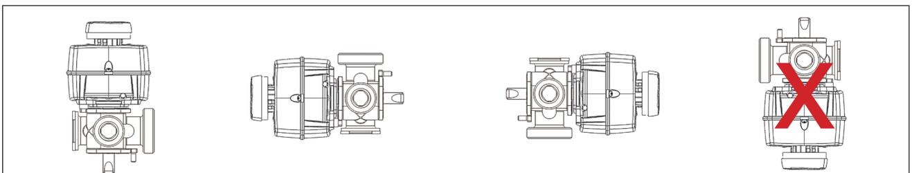
Cambiando la posición del obturador respecto a la válvula, se pueden obtener diferentes configuraciones. Por tanto, durante la primera instalación, es importante alinear las muescas de referencia de la válvula y del motor.
