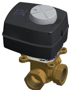
Válvula mezcladora de sector de 3 vías con actuador bidireccional de 3 puntos. PN 10 bar. Temperatura de trabajo: 0÷110°C. Cuenta con cuerpo y rotor en latón y juntas en EPDM. Acoplamientos roscados hembra de 1/2" a 2". Ángulo de rotación de 90° en 120 seg.
