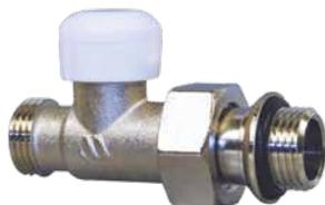
Detentore micrometrico nichelato. Corpo diritto. Attacco per tubo rame o plastico da 1/2" M o M24x1,5. Bocchettone cilindrico con O-Ring. Cappuccio in ABS.
