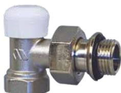
Detentore micrometrico nichelato. Corpo a squadra. Attacco per tubo ferro. Bocchettone cilindrico con O-Ring. Cappuccio in ABS.
