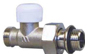
Detentor micrométrico niquelado. Cuenta con cuerpo recto, acoplamiento para tubo de cobre o de plástico de 1/2" macho, racor cilíndrico con junta tórica y capuchón en ABS.
