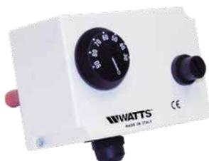
Bitermostato de inmersión de regulación y bloqueo con rearme manual. Dispone de las mismas características del termostato **Serie TRE TU**. Temperatura de regulación:  $30 \div 90^{\circ}\text{C}$ . Tolerancia  $\pm 3^{\circ}\text{C}$ . Temperatura de bloqueo 95°C. Cuenta con bulbo sensible con vaina de 1/2" macho de 100 mm de longitud, caja en plástico con rueda de ajuste exterior y botón de rearme manual. Grado de protección IP40. Potencia de los contactos: 16(5) A 250V. 400V 10(1)A.
