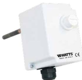
Termostato de bloqueo de inmersión con seguridad positiva, rearme manual y regulación fija. Interrumpe el aporte de calor cuando la temperatura del agua alcanza el valor predeterminado de regulación. Temperatura de regulación: 97°C (tolerancia  $+3 \div -5^{\circ}\text{C}$ ). Cuenta con un bulbo sensible con vaina de 1/2" macho de 89,7 mm de longitud. Potencia de los contactos: 16(5) A 250V. Terminales faston de 6,3 mm con borne de tornillo.
