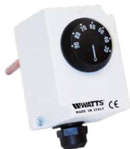
Termostato de regulación de inmersión con 3 contactos conmutables. Interrumpe el aporte de calor cuando la temperatura del agua alcanza el valor predeterminado que puede regularse de 30 a 90°C. Cuenta con un bulbo sensible con vaina de 1/2" macho de 100 mm de longitud y caja de plástico con rueda de ajuste exterior. Grado de protección: IP40. Tolerancia:  $\pm 3^{\circ}\text{C}$ . Potencia de los contactos: 16(5) A 250V. 400V 10(1)A.
