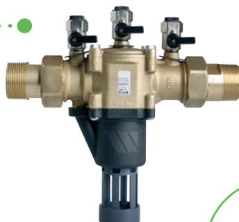
Un desconector BA **protege las redes de agua potable** interrumpiendo el suministro de agua a la instalación, mediante un autovaciado y descarga del fluido al desagüe, en caso de peligro de reflujo en la tubería principal.
