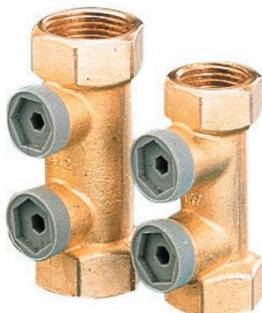
Las válvulas de la Serie EA291, con certificación NF antipolución, se utilizan para proteger las redes de agua potable contra el retorno de fluidos contaminados. Cuentan con 2 tomas agujereadas: una aguas arriba y la otra para aguas abajo para el control de la estanqueidad, el vaciado de la instalación y el control de la calidad del agua.
