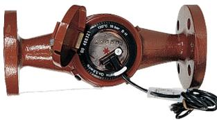
Misuratore a turbina multigetto per acqua calda. Esecuzione PN16. Temperatura fluido massima: 130°C. Lettura diretta a quadrante asciutto con trasmissione magnetica. Attacchi flangiati. Montaggio orizzontale. Completo di trasmettitore di impulsi.
