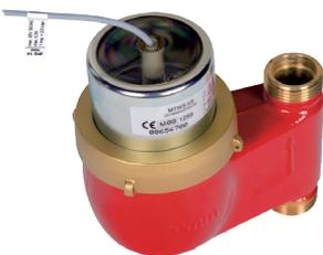
Misuratore a turbina multigetto per acqua calda. Esecuzione PN16. Temperatura fluido massima: 90°C. Lettura diretta a quadrante asciutto con trasmissione magnetica. Corpo in ottone completo di dadi e cannotti. Attacchi filettati. Montaggio verticale con ingresso fluido dal basso. Completo di trasmettitore di impulsi.
