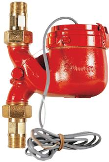
Misuratore a turbina multigetto per acqua calda. Esecuzione PN16. Temperatura fluido max.: 90°C. Lettura diretta a quadrante asciutto con trasmissione magnetica. Corpo in ottone completo di dadi e cannotti. Attacchi filettati. Montaggio verticale con ingresso fluido dall'alto. Completo di trasmettitore di impulsi.
