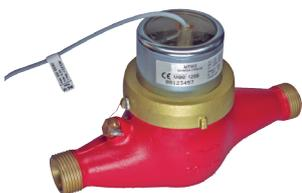
Misuratore a turbina multigetto per acqua calda. Esecuzione PN16. Temperatura fluido massima: 90°C. Lettura diretta a quadrante asciutto con trasmissione magnetica. Corpo in ottone completo di dadi e cannotti. Attacchi filettati. Montaggio orizzontale. Completo di trasmettitore di impulsi.
