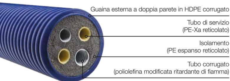
Il sistema di tubi Microflex HP si basa sull'integrazione di quattro (4) elementi ed è fabbricato in conformità alla norma EN 15632:1-3.
