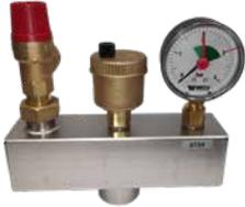
Grupo de seguridad para instalaciones de circuito cerrado conforme con la norma EN 12828. Se instala en colector en acero galvanizado y cuenta con purgador de aire de la Serie MV, válvula de seguridad de 1/2" (3 bar) y manómetro (0÷4 bar) con aguja indicadora ajustable y válvula de retención. Acoplamiento para el grupo de seguridad de 1" hembra. PN 10. Modelos frontales ISO con aislamiento.
