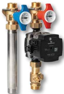
Gruppo di rilancio compatto per circuiti di riscaldamento diretti. Il guscio brevettato, suddiviso in tre elementi e realizzato in EPP, fornisce l'isolamento termico, in conformità alla normativa tedesca GEG (Gebäudeenergiegesetz - Legge sul risparmio energetico in edilizia). Facile installazione a parete con l'impiego di una sola vite. Sono inclusi la staffa di fissaggio a parete e le chiusure. 2 attacchi integrati per i sensori di temperatura.
