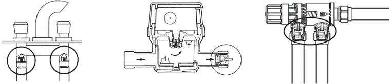
Protège le réseau d'eau potable des contaminations par retour d'eau dû à la hauteur manométrique, par contre-pression ou siphonnage.
