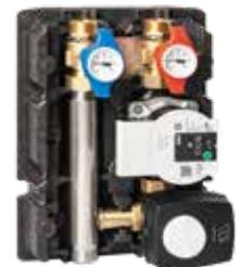
Pression de service maximale : 6 bar. Température ambiante minimale : -10 °C. Température ambiante maximale : +40 °C. Température d'utilisation minimale : +2 °C. Température d'utilisation maximale : +90 °C (voir les consignes du circulateur !). Pression d'ouverture de la vanne d'inversion de pompe: 10 mbar. Plage de température : 0 à 120 °C. Max 24kW à  $\Delta T=20K$ ,  $\Delta p=100\text{mbar}$ .
