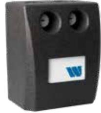
Pression de service maximale : 6 bar. Température ambiante minimale : -10 °C. Température ambiante maximale : +40 °C. Température d'utilisation minimale : +2 °C (voir les consignes du circulateur !). Température d'utilisation maximale : +90 °C. Pression d'ouverture de la vanne d'inversion de pompe: 10 mbar. Plage de température : 0 à 120 °C. Max. 55 kW à  $\Delta T=20K$ ,  $\Delta p=100\text{mbar}$ .
