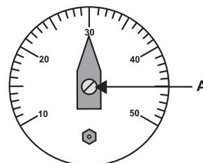
Une fois la manette enlevée, dévisser la vis "B" et la butée "C", remplacer le cadran 10/50°C par le 30/70°C (réf 22TB100740U), resserrer la vis "B" et la butée "C", puis repositionner la manette en face du repère 30°C. Revisser la vis "A", c'est fini !
