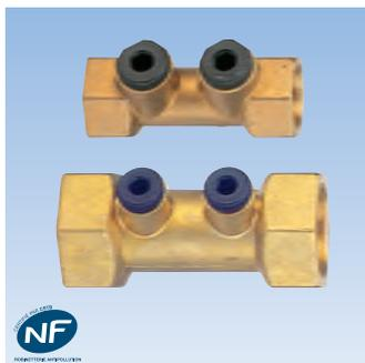
Clapet antipollution contrôlable type de protection EA. Fonctionnement silencieux, faibles pertes de charge. Étanchéité totale même avec une très faible contre-pression. Corps laiton F/F muni de deux bossages F 8x13 avec bouchons PA (polyamide) de couleur noire. Clapet POM (polyacétal), ressort acier inox, joint NBR (nitrile).
