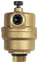
Valvola automatica sfogo aria verticale. Corpo e coperchio in ottone CW617N. Preguarnito con O-Ring. PN12. Temperatura massima: 110°C. Adatto anche per acqua additivata (glicole fino al 50%).
