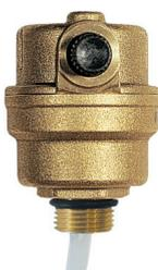
Valvola automatica sfogo aria laterale. Corpo e coperchio in ottone CW617N. Preguarnito con O-Ring. PN12r. Temperatura massima: 110°C.
