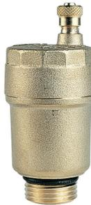
Valvola automatica sfogo aria verticale. **Preguarnita O-Ring.** Adatta per installazione sugli attacchi di testa dei collettori complanari. Corpo in ottone CW617N. PN 10 bar. Temperatura massima: 110°C
