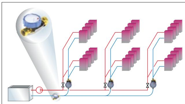
Pas besoin de longueurs droites en amont en aval de la vanne iDROSET®.
