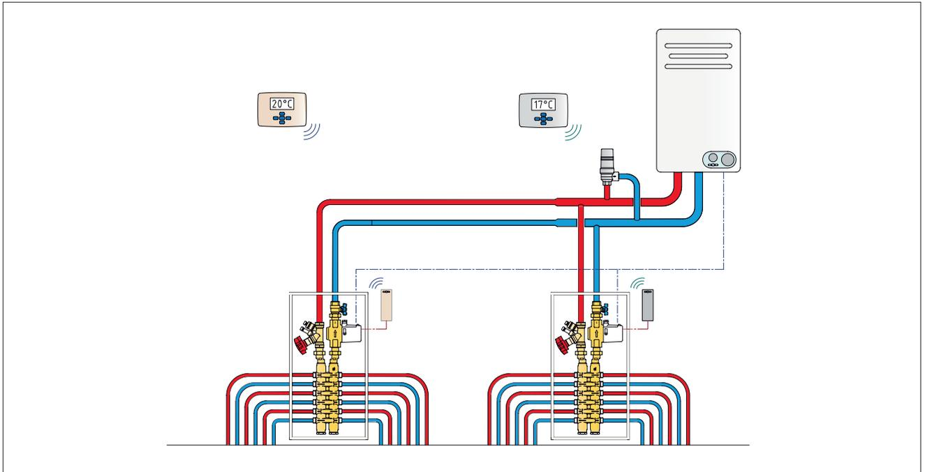
Impianto con valvole di zona a 3 vie quattro attacchi **Serie 561T** completo di attuatore elettrotermico **Serie 580T** e distribuzione con collettore complanare Modul, regolatore della temperatura ambiente con programmatore su almeno due livelli di temperatura (**Serie MILUX**).
