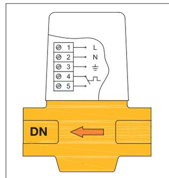
**ATTENZIONE:** Quando l'attuatore **Serie 580T** è separato dal corpo valvola, il microinterruttore si trova in posizione casuale e potrebbe quindi risultare chiuso benché il contatto sia normalmente aperto (NA). Il contatto funziona correttamente solo quando l'attuatore è montato sul corpo valvola.
