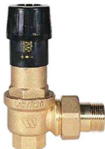
Válvula de sobrepresión para instalaciones con válvulas de corte automáticas o manuales en cuerpos calentadores (válvulas termostáticas, válvulas de zona de dos vías). Cuenta con acoplamientos hembra de entrada, racor macho de salida, cuerpo y casquete en latón CW617N.
