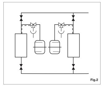
Nel dimensionare la tubazione di sicurezza bisogna tenere conto della resistenza della valvola a tre vie, aumentando la lunghezza virtuale di cento volte il diametro interno della tubazione stessa. Alla tubazione di sicurezza calcolata andranno quindi sommati i seguenti valori:
