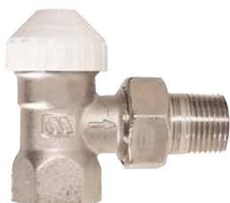
Vernickeltes Heizkörperventil. Eckform. Anschluss für Eisenrohre. Nippel mit O-Ring. Handrad aus ABS mit beweglicher Spindel. Kompatibel mit Thermostatköpfen **Serie 148WM** und mit elektrothermischen Stellantrieben **Serie 22CX** und **26LC**. Nach UNI EN 215 Konforme in Verbindung mit Thermostatköpfen **Serie 148WM (SE148)**.
