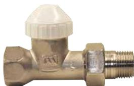
Vernickeltes Heizkörperventil. Durchgangsform. Anschluss für Eisenrohre. Nippel mit O-Ring. Handrad aus ABS mit beweglicher Spindel. Kompatibel mit Thermostatköpfen **Serie 148WM** und elektrothermischen Stellantrieben **Serie 22CX** und **26LC**. Nach UNI EN 215 Konforme in Verbindung mit Thermostatköpfen **Serie 148WM (SE148)**.
