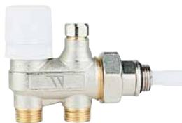
Válvula termostaticable niquelada de cuatro vías para **instalaciones monotubo con by-pass fijo**, con dispositivo de **prerregulación**, detentor incorporado y acoplamiento para tubo de cobre o plástico. Cuenta con racor cilíndrico con junta tórica, separador de flujo y rueda de ajuste en ABS. Presión diferencial (**Serie 148 y 148A**): 1,5 bar. Caudal al cuerpo calefactor: 50%
