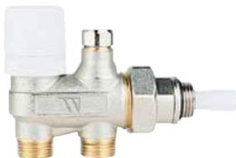
Válvula termostaticable niquelada de cuatro vías para **instalaciones bitubo**, con dispositivo de **prerregulación**, detentor incorporado y acoplamiento para tubo de cobre o plástico. Cuenta con racor cilíndrico con **junta tórica**, separador de flujo y rueda de ajuste en ABS. Presión diferencial (serie 148 y 148A): 1,5 bar.
