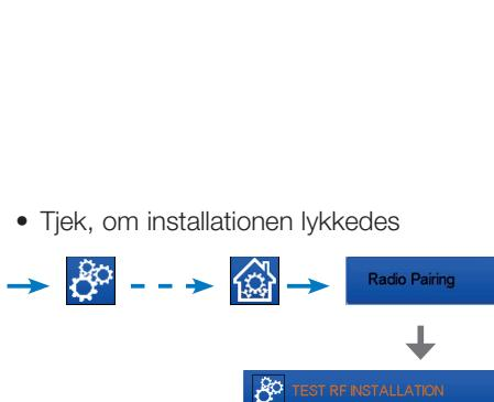
Der vil komme en advarsel på startmenuen for RF-fejlkommunikationer. Advarselsflaget skal blive vist i maks. 10 min. Derefter slukker det, hvis der ikke er kommunikationsproblemer. Hvis det ikke sker, skal de enheder, der viser RF-fejl tjekkes; prøv eventuelt at flytte dem til et andet sted, og gentag proceduren.
