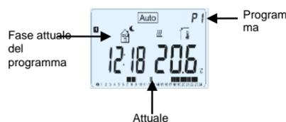
È possibile disabilitare temporaneamente il programma attuale premendo (-) o (+). Il termostato passa alla modalità Timer, in cui è possibile selezionare un punto di regolazione e un'ora. Il termostato ritorna automaticamente alla modalità Automatica alla fine del periodo determinato.
