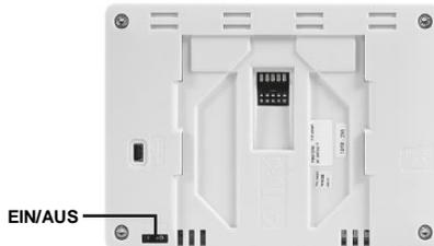
4. Setzen Sie die Zentrale auf die Anschlussplatte und schieben diese nach unten bis die Arretierung einrastet. Die Zentrale ist nun betriebsbereit.
