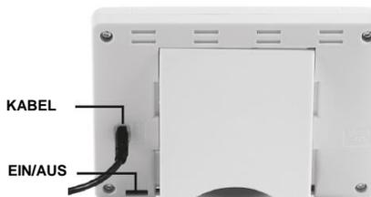
Netzteil mit USB Kabel (5V, 1A) einstecken und Tischaufsteller an der Rückseite anbringen. Schalten Sie die Zentrale EIN. Die Zentrale ist nun betriebsbereit.
