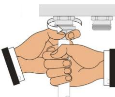
**RU** Закрутите вручную накидную гайку. Труба должна быть вставлена при этом до упора.
