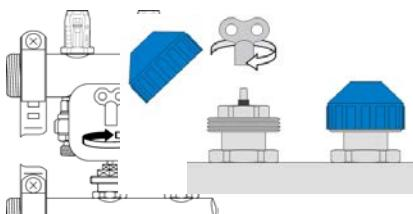
**RU** Снимите защитный колпачок и закройте клапан вращением (вправо) по часовой стрелке с помощью ключа воздухоотводчика (входит в комплект поставки).
