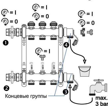
**RU** Закройте шаровые краны ① + ②. Закройте все регулирующие клапаны при помощи пластиковых колпачков (вращение по часовой стрелки до упора). Подключите шланг для наполнения и промывки к сливному крану концевой группы ③ поддающего патрубка; сливной кран ④ концевой группы обратного патрубка должен быть полностью открыт!
