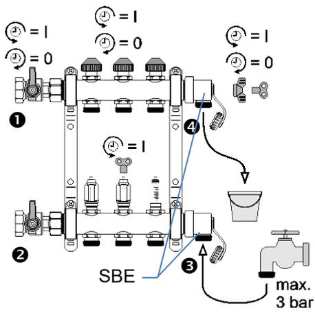
**Durchfluss Einregulierung / Flow adjustment / Réglage du débit / Regolazione del flusso / Ajuste del caudal/ Регулировка расхода:**
