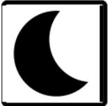
Betrieb nach Absenktemperatur dauerhaft oder einige Stunden oder Tage (siehe Urlaub Funktion). Durch drücken von + oder – beginnt die Absenktemperatur zu blinken und kann entsprechend geändert werden. Nach einigen Sekunden erscheint wieder
