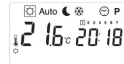
Durch Drücken der Taste (OK) kann die Komfort-Solltemperatur angezeigt werden.
