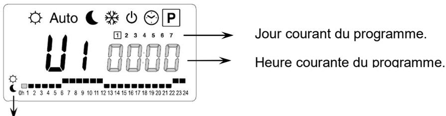
La touche (+) permet de sélectionner une température de CONFORT à la position du curseur. La touche (-) permet de sélectionner une température ECO à la position du curseur
