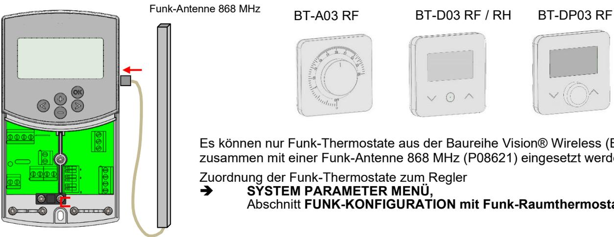
Es können nur Funk-Thermostate aus der Baureihe Vision® Wireless (BT02/03 RF) zusammen mit einer Funk-Antenne 868 MHz (P08621) eingesetzt werden.
