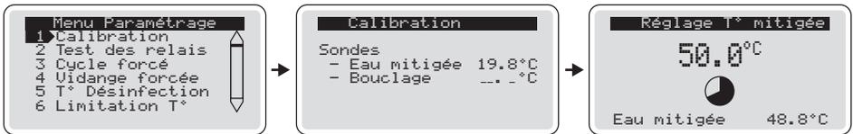
Faire couler l'eau à la température habituelle d'utilisation et calibrer la sonde de température d'eau mitigée directement sur la centrale par rapport à la température mesurée avec le thermomètre de référence.
