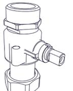
KH lang Kugelhahn<br>für Vorlauf der HK20 1"AG<br>x 1"Fl., L=86mm<br>inkl. Dichtungen                                      | 10080048 |
