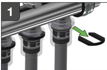
**DE:** Heizkreisverteiler und den entsprechenden Heizkreis absperren. Sicherheitsklammer (2) mit einem Schraubenzieher entfernen.
