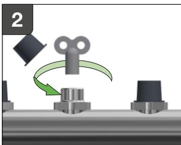
**DE:** Der Volumenstrom wird durch Linksdrehen der Regulierspindel eingestellt. Die Anzahl der Umdrehungen anhand des Diagramms "Einstellung des Regulierventils" auf Seite 7.
