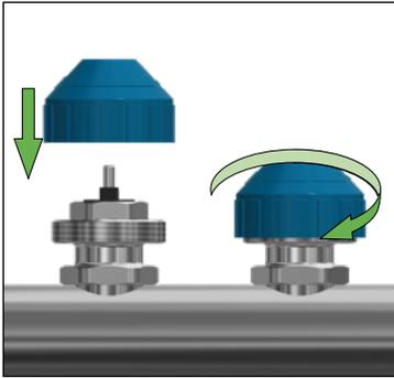
**DE:** Die Absperrventile im Rücklauf können, z.B. für das Spülen und Befüllen der Heizkreise, geschlossen werden. Dazu die Bauschutzkappe aufsetzen und Ventil rechtsdrehend schließen.
