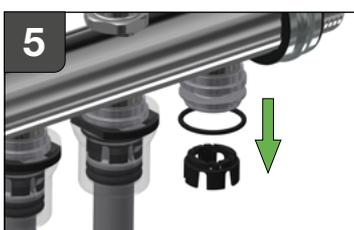
**DE:** O-Ring (3) und Krone (4) vom Messing-Grundkörper (1) entfernen.
