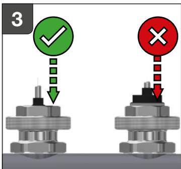
**DE:** Das Feingewinde der Einstellspindel darf nicht oberhalb des Sechskants SW19 zusehen sein! Das Ventil ist, ausgehend vom geschlossenen Zustand, mit 2,5 bis 3 Linksdrehungen geöffnet (voller Durchfluss).
