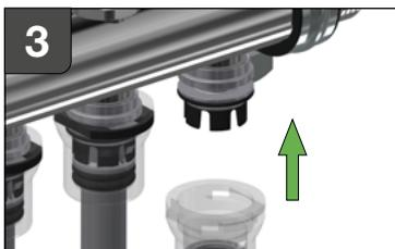
**DE:** Push'n'Go Ersatzteil auf den Grundkörper (1) aufstecken.
