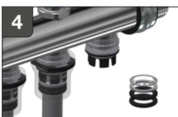
**DE:** Edelstahl-Krallerring (5) mit einer Schneidzange durchschneiden und zusammen mit den O-Ringen (7) und den Abstandshalter (6) vom Rohr entfernen.
