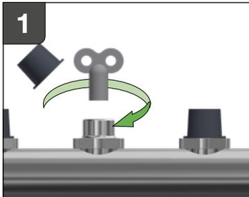
**DE:** Die Durchflussmenge wird an den Regulierventilen am Vorlauf eingestellt. Schutzkappe entfernen und Ventil durch Rechtsdrehen mit Entlüfterschlüssel schließen (= kleinster Wert).
