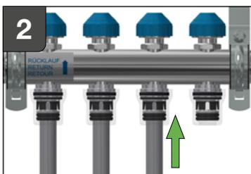
**DE:** PE-X Rohr bis zum Anschlag in den Push'n'Go Connector schieben.
