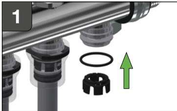
**DE:** Das Ersatzteilset besteht aus Teilen 2-8. Den O-Ring (3) auf den Rand des Grundkörpers (1) aufschieben und Krone (4) auf den Grundkörper (1) aufdrücken.
