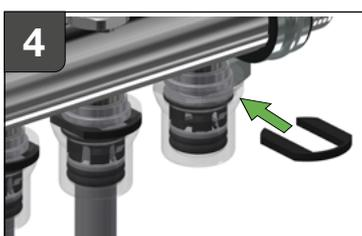
**DE:** Push'n'Go mit Hilfe der Sicherheitsklammer (2) fixieren. Abschließend das PE-X Rohr wie in Abschnitt „7.1 Montage der Rohre“ auf Seite 10 beschrieben montieren.
