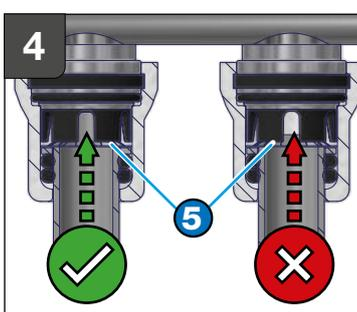
**DE:** Korrekte Position des Rohres Anhand des Schaufensters überprüfen. Das Rohr muss deutlich oberhalb des Krallenrings (5) fixiert sein und das Schaufenster komplett ausfüllen.
