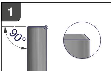
**DE:** PE-X Rohr (DIN EN ISO 15875-2) senkrecht zur Achse mit einem Rohrschneider abschneiden. Rohrenden entgraten und anfasen, um eine Beschädigung der O-Ringe beim Einführen zu vermeiden. Rohre spannungsfrei montieren.
