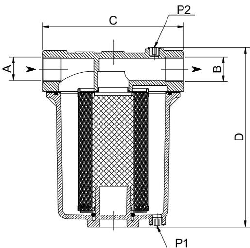
**P1:** presa pressione in ingresso / inlet pressure tap / штуцер отбора давления на входе
