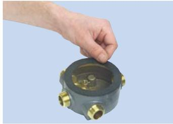
Steuerelement umgekehrt auf das Gerät und die Flachdichtung legen.
