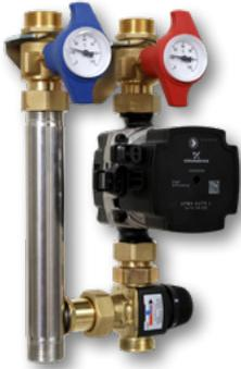
Kompakte Pumpen - Mischerguppe zur Festwertregelung der Vorlauftemperatur thermostatisch geregelt. Einstellbereich: 20 - 55 °C oder 30 - 70 °C. 3-teilige patentierte EPP - Isolierschale, Wärmedämmung nach GEG. Einfache Wandmontage mit nur einer Schraube. Verdeckte Kabelführung auf der Rückseite der Isolierschale. Inkl. Wandhalterung und Befestigung. 2 integrierte Temperaturfühleranschlüsse.
