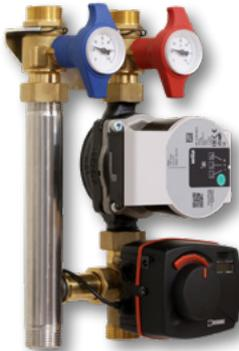
Kompakte Pumpen - Mischerguppe zur Festwertregelung der Vorlauftemperatur elektronisch geregelt. Einstellbereich: 5 - 95 °C<sup>1)</sup>. 3-teilige patentierte EPP - Isolierschale, Wärmedämmung nach GEG. Einfache Wandmontage mit nur einer Schraube. Verdeckte Kabelführung auf der Rückseite der Isolierschale. Inkl. Wandhalterung und Befestigung. 2 integrierte Temperaturfühleranschlüsse.
